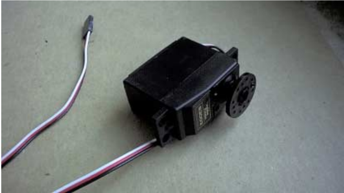
Slika 3: Servo-motor iz R/C modelov in element, ki ga lahko uporabimo za kolo.
