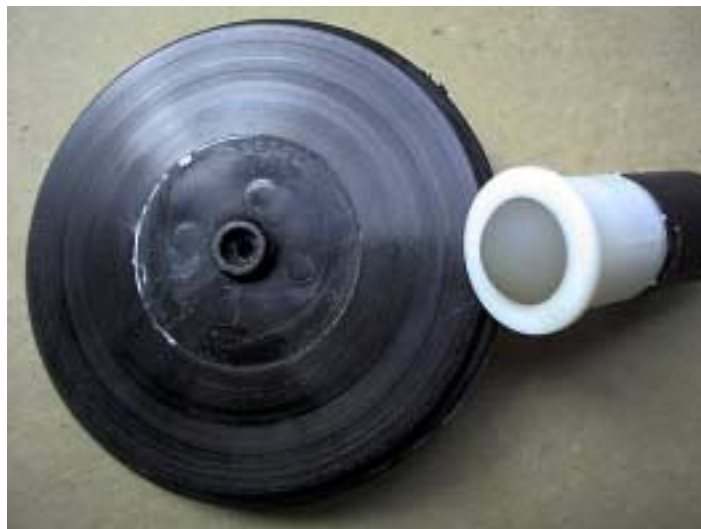
Slika 1: Na desni prostovrteče kolo; na levi pa kolo iz plastične mase obdano z gumo, na sredini pa je prilepljen element za pritrditev na servo-motor.
