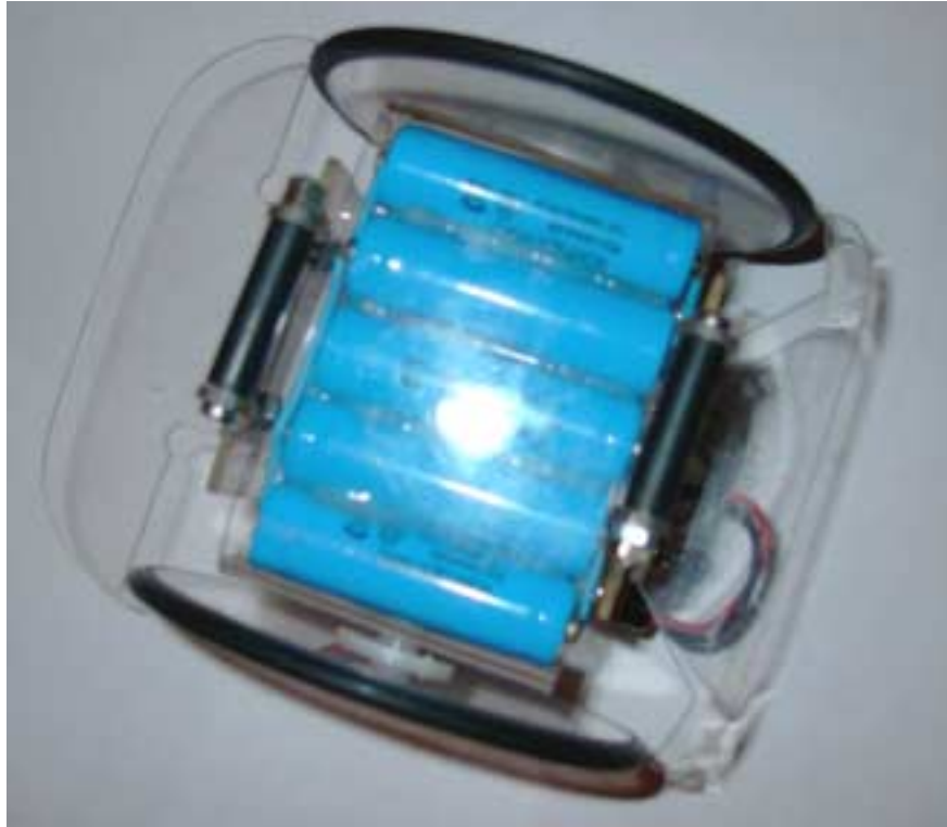
Slika 2: Od spodaj sta lepo vidni pogonski kolesi in valjčka, ki robotu pomagata pri stabilnosti
